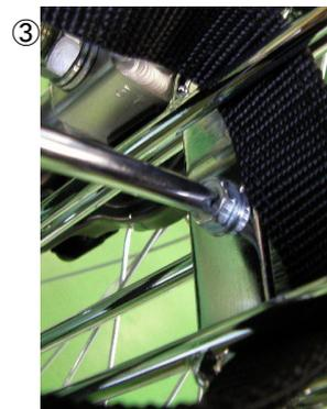
③ ガタつきがないようプラスドライバーと10mmスパナで3箇所のボルトを締めます。
