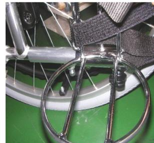
①ボンベ架を付ける側の本体ティッピングレバーに延長ティッピングレバーを差し込み、固定用ボルトをスパナで締め込みます。
