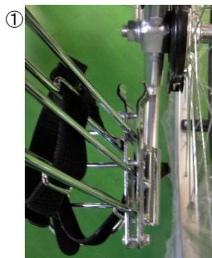
① ボンベ架をティッピングレバーに差し込みます。
